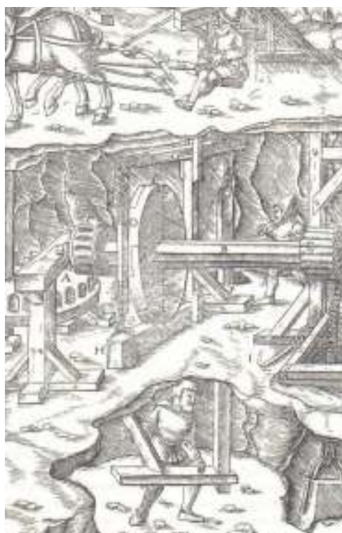
Obr. 1.154 Konský pohon banských mechanizmov. A – palcové koleso na svislej osi, B – vodorovná os, C – prevodové vreteno, D – kotúč, E – lanový bubon z kolíkov, F – hák, G – pohyblivá klada, H – brzdiaci klátik, I – druhý hák [1]
