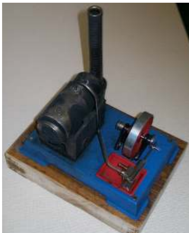
Obr. 1.240 Funkčný model jednočinného parného stroja z autorovej zbierky
