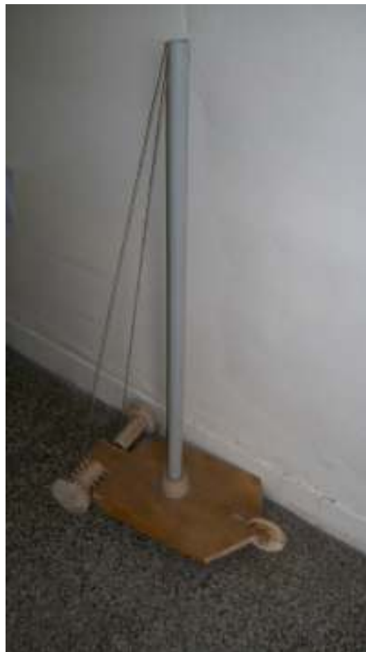
Obr. 1.100 Mechanický programovateľný vozík (autorova replika)
