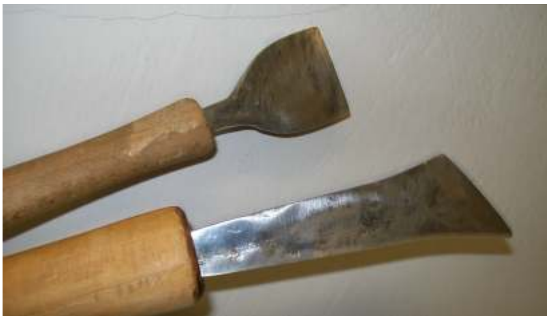
Obr. 3.38 Originálne nástroje na sústruženie na šliapacom sústruhu (zbierka autora)
