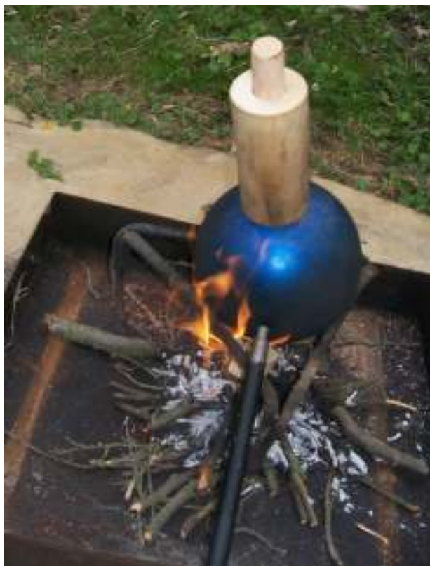
Obr. 1.73 Autorov zmenšený model Archimedovho „parného kanóna“. Dole piestová striekačka na vstreknutie vody
