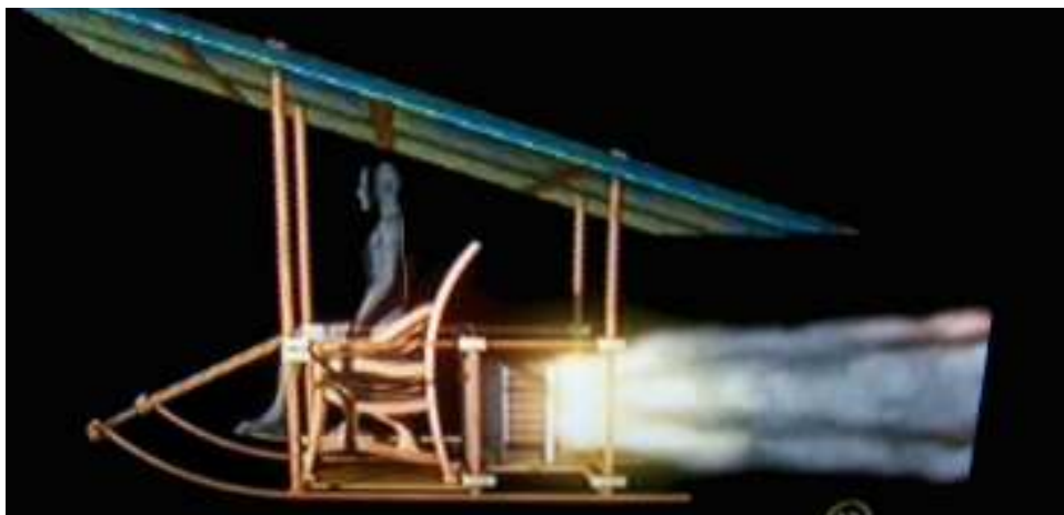
Obr. 1.117 „Raketová stolička“ z Číny. Vzadu je 40 bambusových rakiet so strelným prachom.
