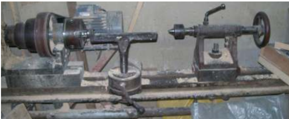
Obr. 3.69 Klasický sústruh na drevo (vľavo stupňovitý remeňový prevod od elektromotora)
