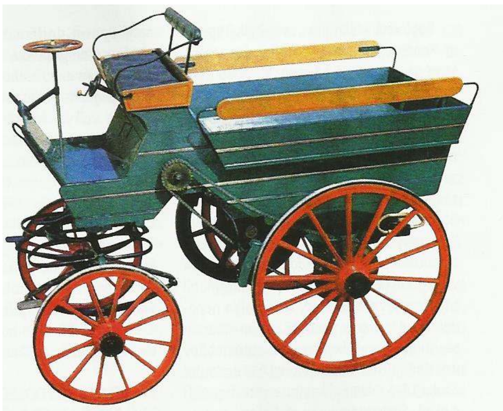
Obr. 1.344 Experimentálny automobil pradiarskeho podnikateľa EDUARDA DELAMARE- DEBOUTTEVILLA s výbušným motorom nad zadnou osou vozidla
