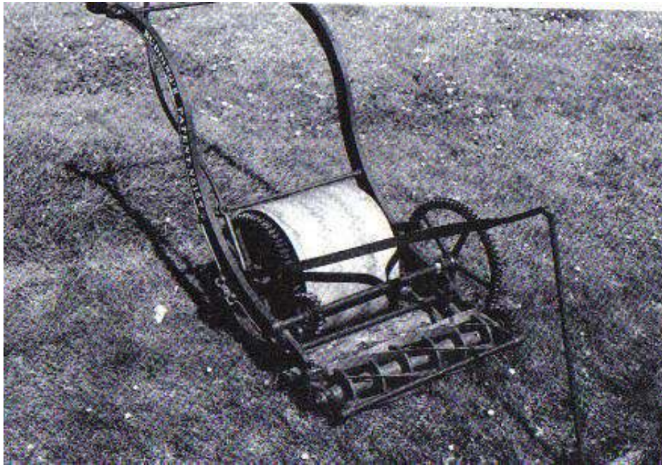
Obr. 4.28 Britský stroj na kosenie trávy. Zariadenie ťahal kôň, alebo vól a roľník viedol kosačku za rukoväť. Nožové koleso poháňal prevodom valec (vpredu)
