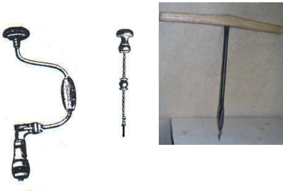
Obr. 3.40 Kolovrátok, alebo „prsná vŕtačka“, ručný vrtáčik na malé dierky do dreva, „svidrik“ a vratidlový vrták „nebožiec“
