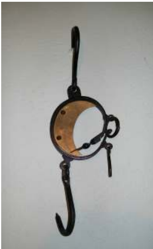
Obr. 5.12 Mincier z autorovej zbierky. Používal sa v mlynoch na váženie vriec obilia a múky. Pri tomto upevnení meria do 200 kg. Z opačnej strany je stupnica do 22 kg. Náklad je však uchytený na háky na konci pružného rámu. Po únave pružiny sa nulová poloha kalibrovala ohnutím kovovej ručičky
