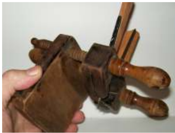
Obr. 2.28 Rímsky hoblík (1) a súprava novších hoblíkov na drážky sudov (zbierka autora)., 2 - drážkovací hoblík na drážky suda, 3 - nastaviteľný drážkovací hoblík
