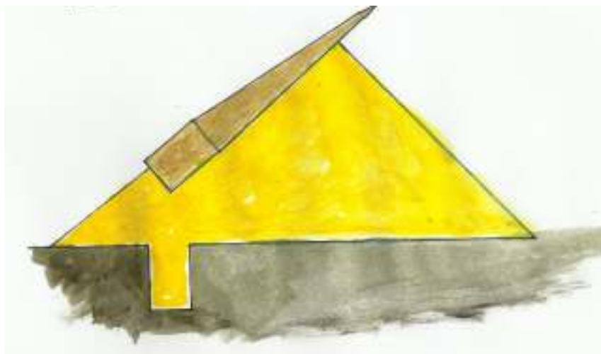
Obr. 1.167 Stavenie obelisk v Egypte pomocou pieskovej kupoly
