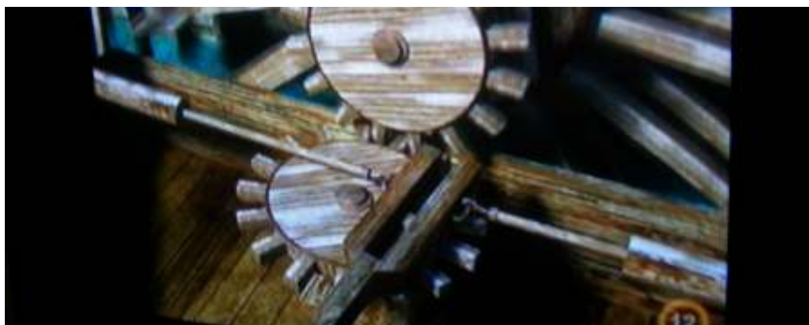
Obr. 1.110 Model mechanizmu AL DŽAZARIHO čerpadla.
