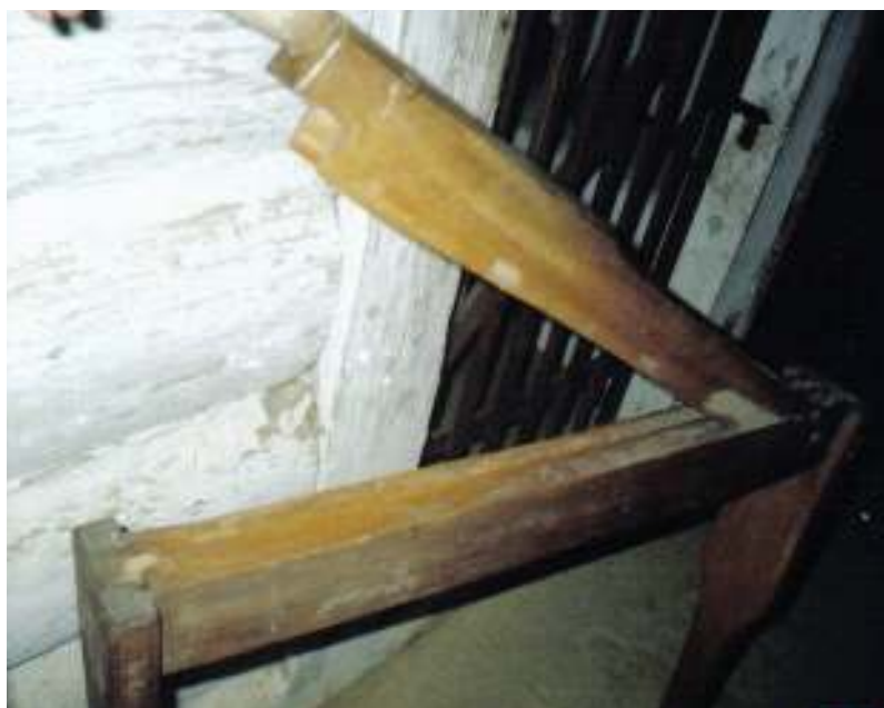
Obr. 6.3 Trlica-potieračka (má dva žliabky)
