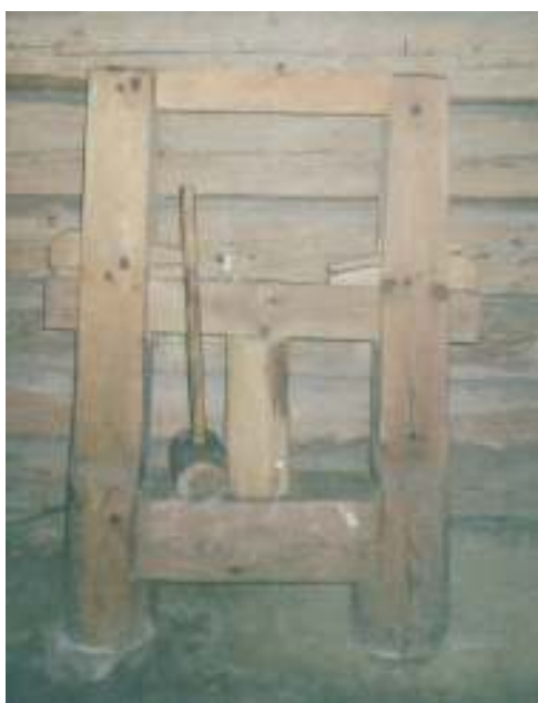
Obr. 4.25 Drevený lis (kyjanicou sa z oboch strán vbíjajú klíny , ktoré tlačia cez priečnik na piest)
