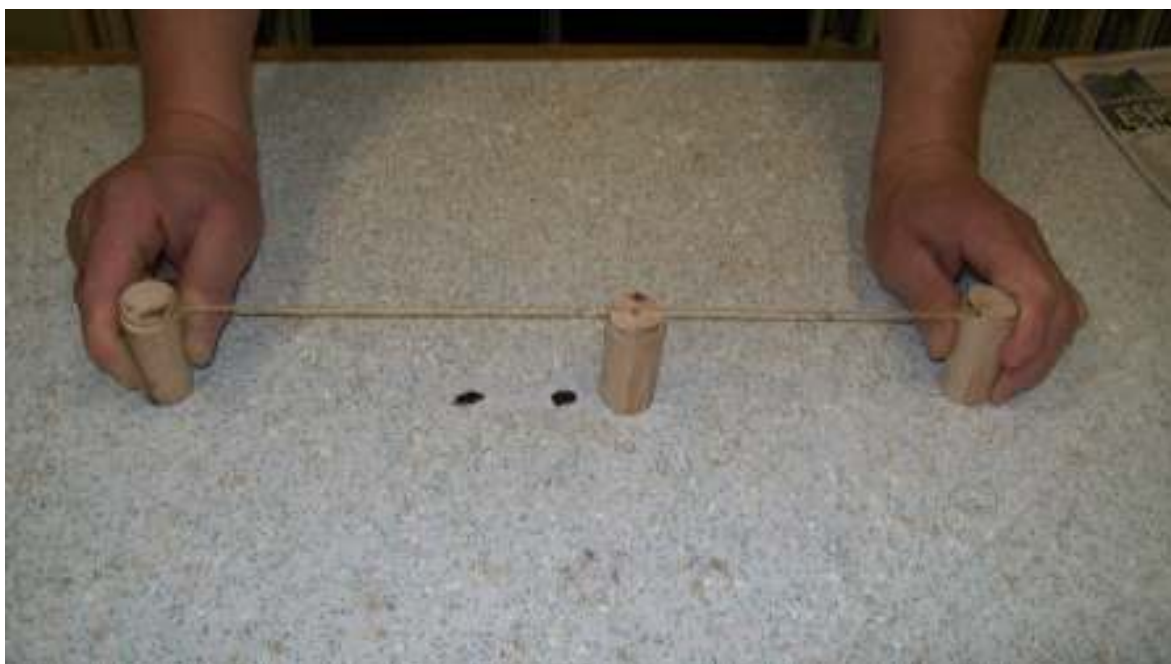
Obr. 5.5 Technika vyrovnávania výstupkov na mramorovom kameni
