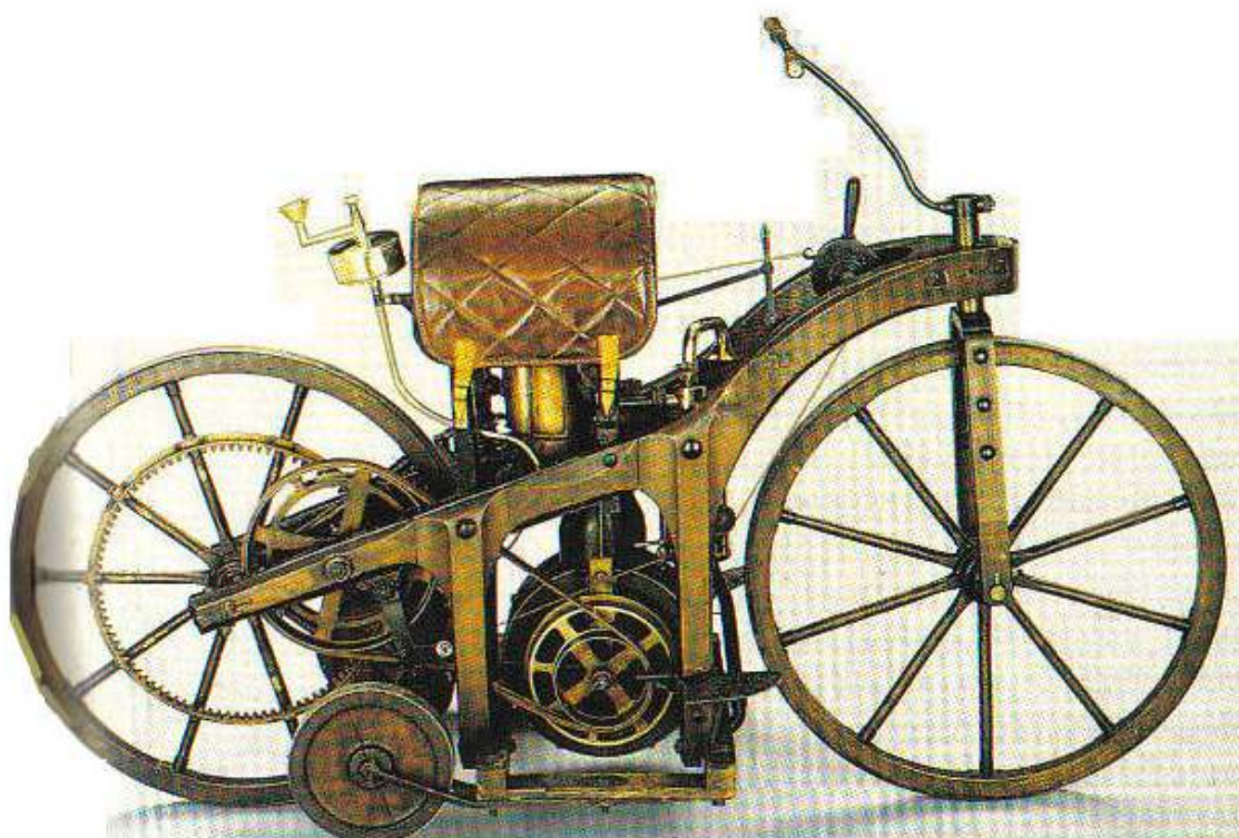
Obr. 1.349 Motocykel s rýchlobežným spaľovacím motorom, 1885 autori a motocykel. WILHELM MAYBACH (1846-1929), GOTTLIEB WILHELM DAIMLER (1834-1900) [21]. Vpravo Daimlerov ľahký automobil jeho typickej konštrukcie
