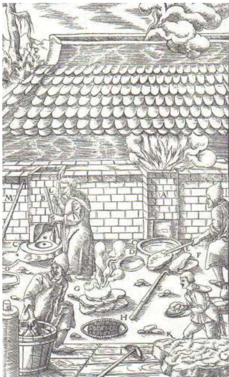
Obr. 2.41 Práca tavičov podľa AGRICOLU. A,B – pece, C-horné predpecie, D-dolné predpecie. Hutník sťahuje trosku F zahnutou tyčou E. G-Pomocník hasí žeravú trosku zalievaním. H-pletená ošatka z prútia, I-hrabačka, K-ruda na tavenie. Pri peci B majster pripravuje predpecie, ubíja ubíjadlami L. M-tyč[1]
