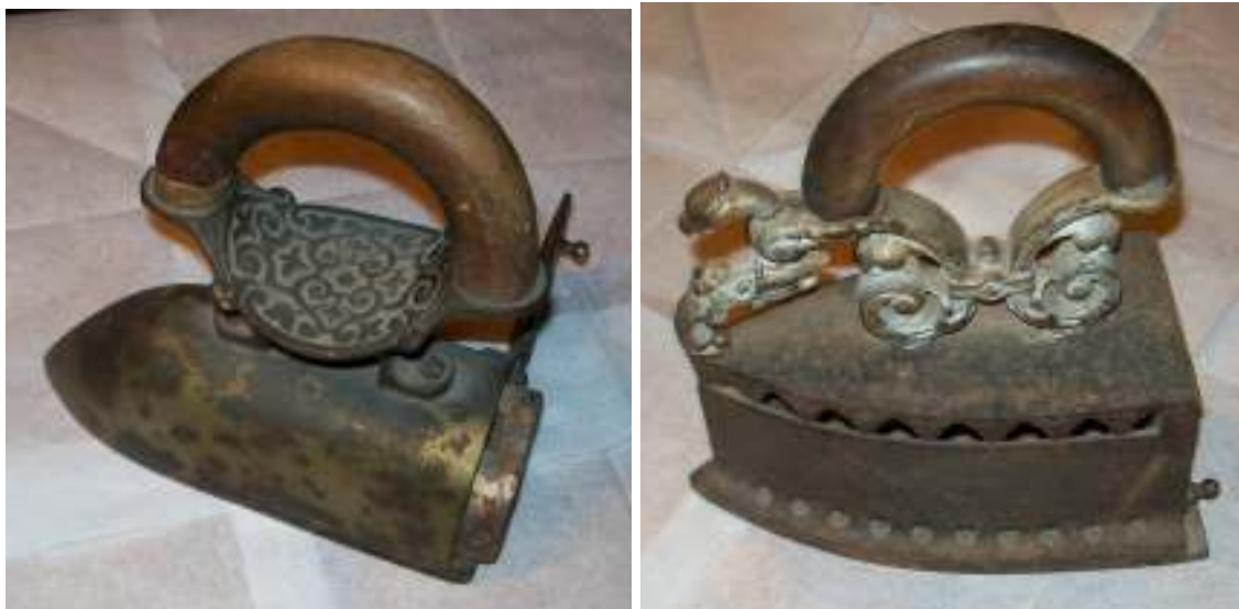
Obr. 6.13 Staré žehličky s ohrievaním vložkou a na drevené uhlie (zbierka autora)
