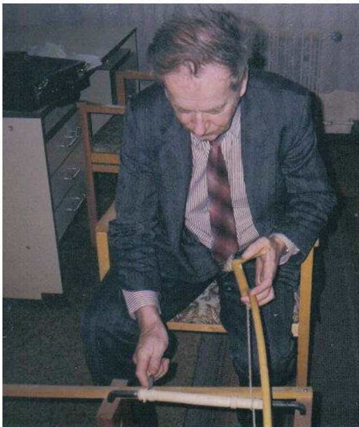
Obr. 3.24 Autorov pokus o sústruženia drevenej pišťalky na lukovom sústruhu (tentoraz už s opierkou)
