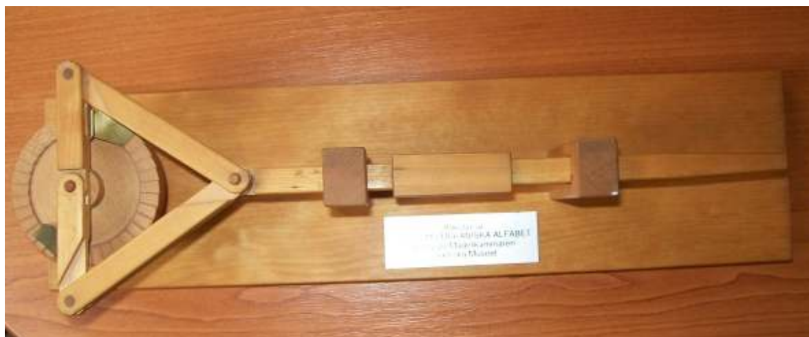
Obr. 1.291 Model pákového palalelogramového prevodu lineárneho pohybu na rotačný.
