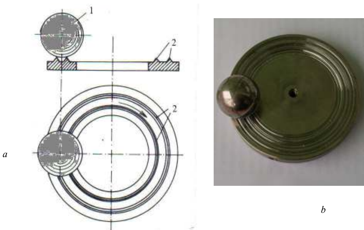
Obr. 1.210 Princíp „samobežnej gule“ – a; 1 – zohriata guľa, 2 – koľajničky, autorov model - b
