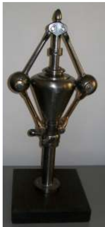
Obr. 1.222 Wattov odstredivý regulátor prívodu pary (Slovenské technické múzeum Košice) a jeho funkcia, vľavo
