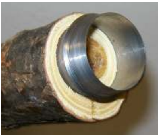
Obr. 3.28 Originálny kovový prstenec na vodotesné spájanie rúr (foto autor Múzeum ľudovej architektúry Bardejovské Kúpele), a zmenšený model jeho upevnenia v kmeni
