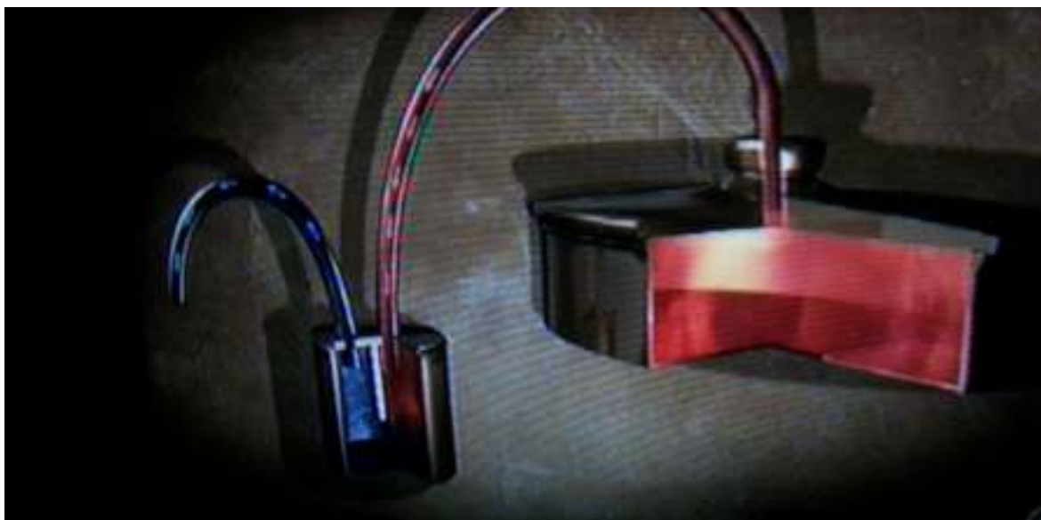
Obr. 1.98 Princíp čerpania kvapaliny tlakom teplého vzduchu
