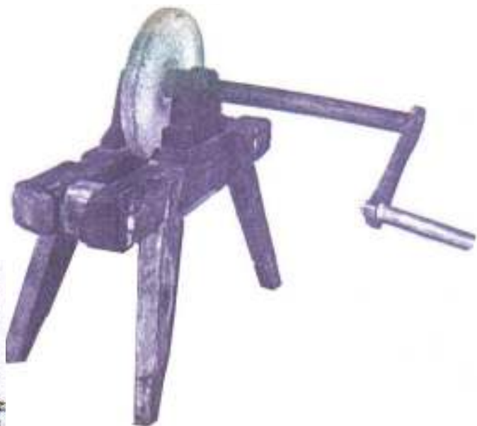
Obr. 3.22 Ručná brúska s kotúčom z pieskovca
