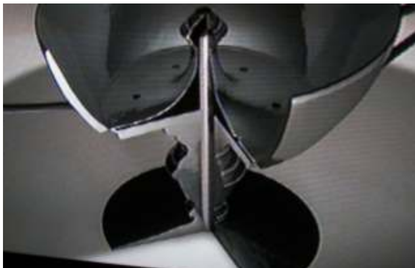
Obr. 1.102 „Obmedzovač opitosti“ podľa Heróna
