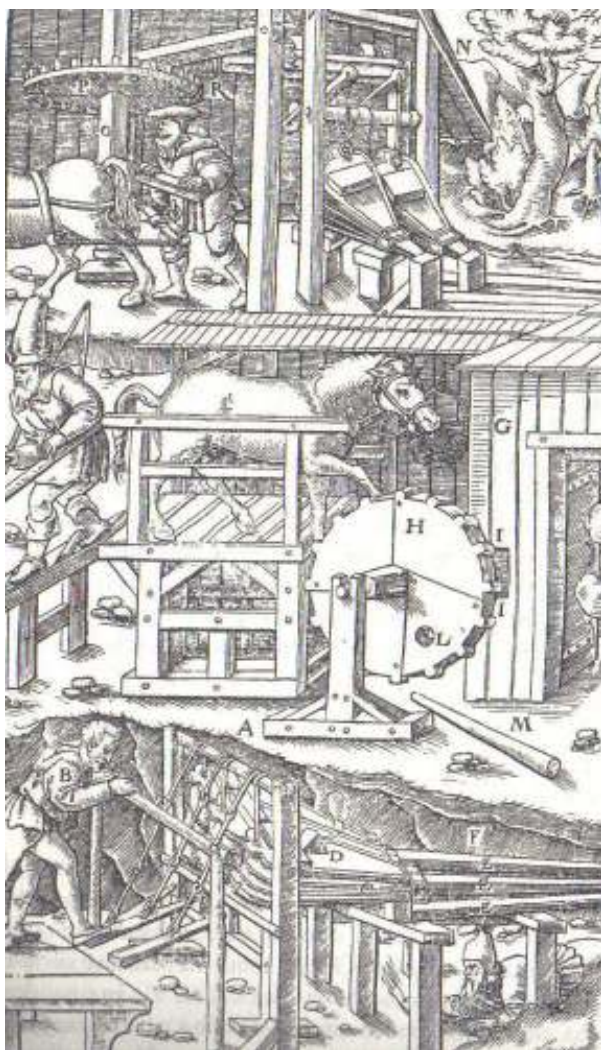
Obr. 1.155 Čerpanie vody šliapacím kolesom a mechmi (čety). A – hriadele, B – šliapacie koleso, C – ozubené koleso, D – prevodový bubon, E – bubon so skobami, F – druhé koleso, G – čety [1]
